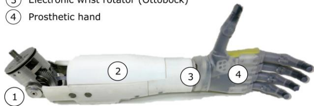
Prototype de prothèse de bras utilisé pour les essais, composé d'un coude motorisé (1), d'un rotateur motorisé de poignet (3) et d'une main polydigitale Robolimb de Touch Bionics (4). © E. Montalivet 2018.
